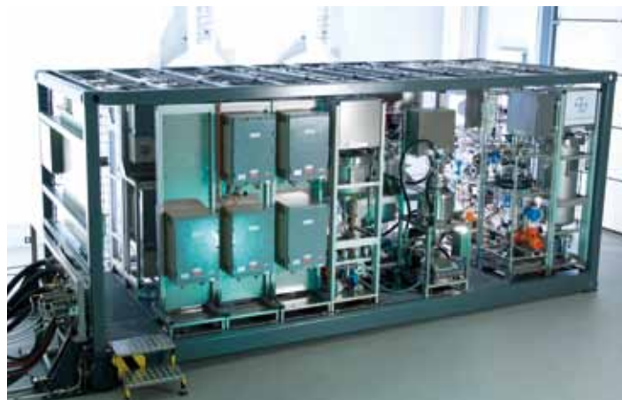
Die Produktionscontainer des Projekts F 3 -Factory funktionieren nach dem Baukasten-Prinzip mit genormten Modulen
